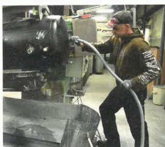
Christian Roitzsch beim Befüllen der Boiler mit flüssiger Emaille. In eine neue Produktionsstrecke werden dieses Jahr etwa 2,5 Millionen Euro investiert.
