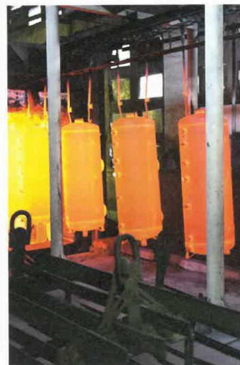
In der Produktion verlassen die emaillierten Boiler den Brennofen.
